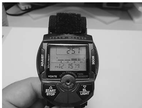
写真5-3 0.1℃単位で表示されたデジタル温度計
