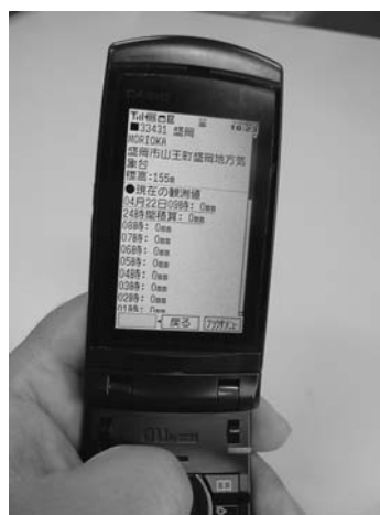
写真1-3 携帯電話からリアルタイム雨量を見る 筆者作成の「リアルタイム雨量表示システム」。いつでもどこでも豊富な災害情報が得られるようになったが, その情報をどう活用するかが大きな問題である。
